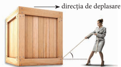
Figura 9 Corp în mișcare uniformă acționat de o forță care formează un unghi cu direcția mișcării
