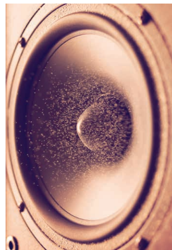
Figura 4 Membrana vibrantă a difuzorului
